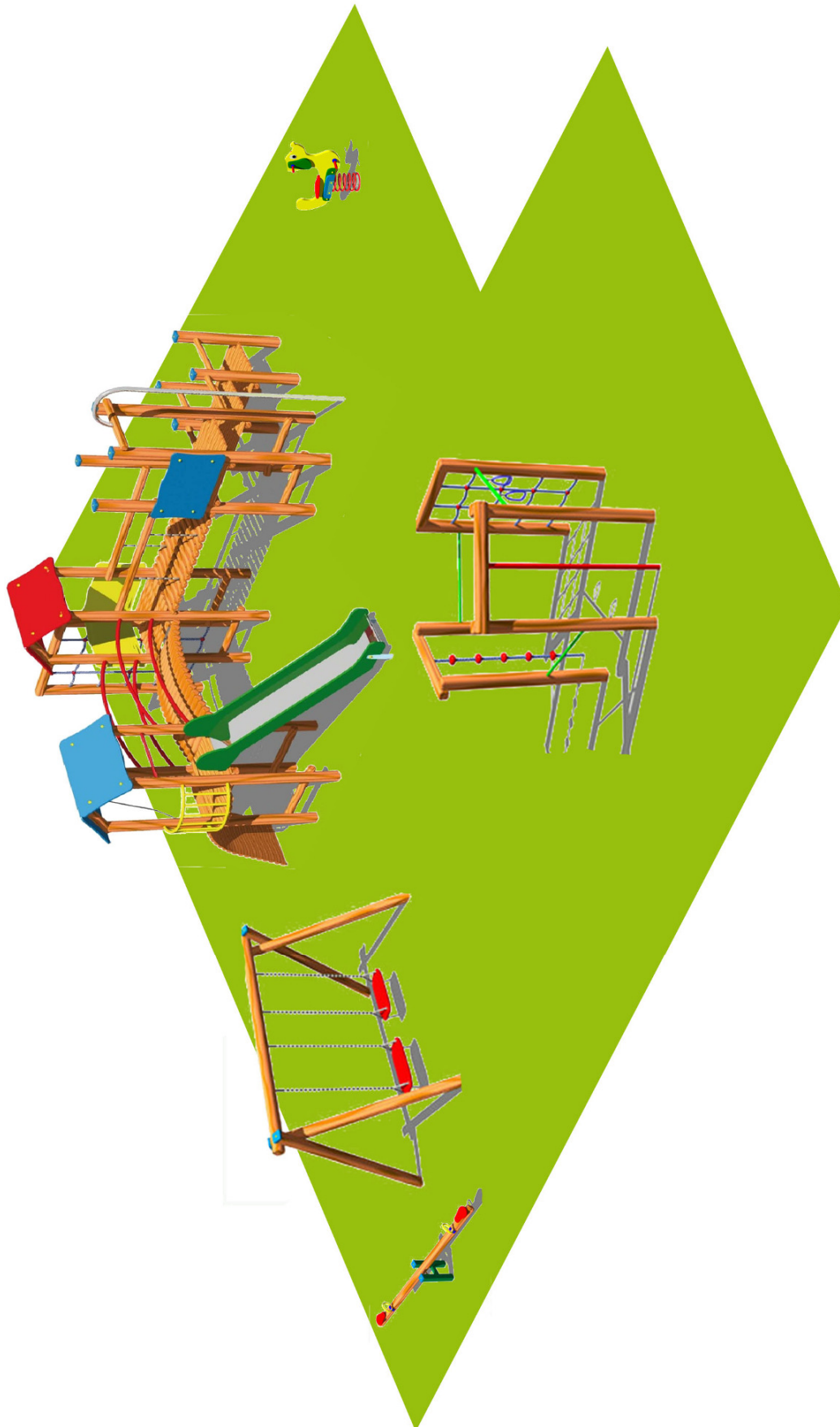
Przykładowe ustawienie urządzeń z zachowaniem stref bezpieczeństwa
