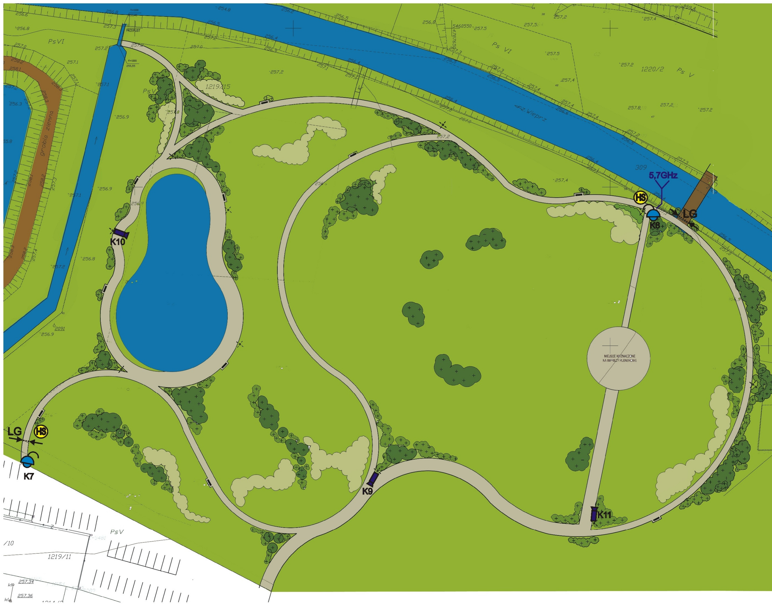
Rys. nr 3. Sugerowane rozmieszczenie elementów teletechnicznych na terenach rekreacyjnych w Krasnobrodzie
