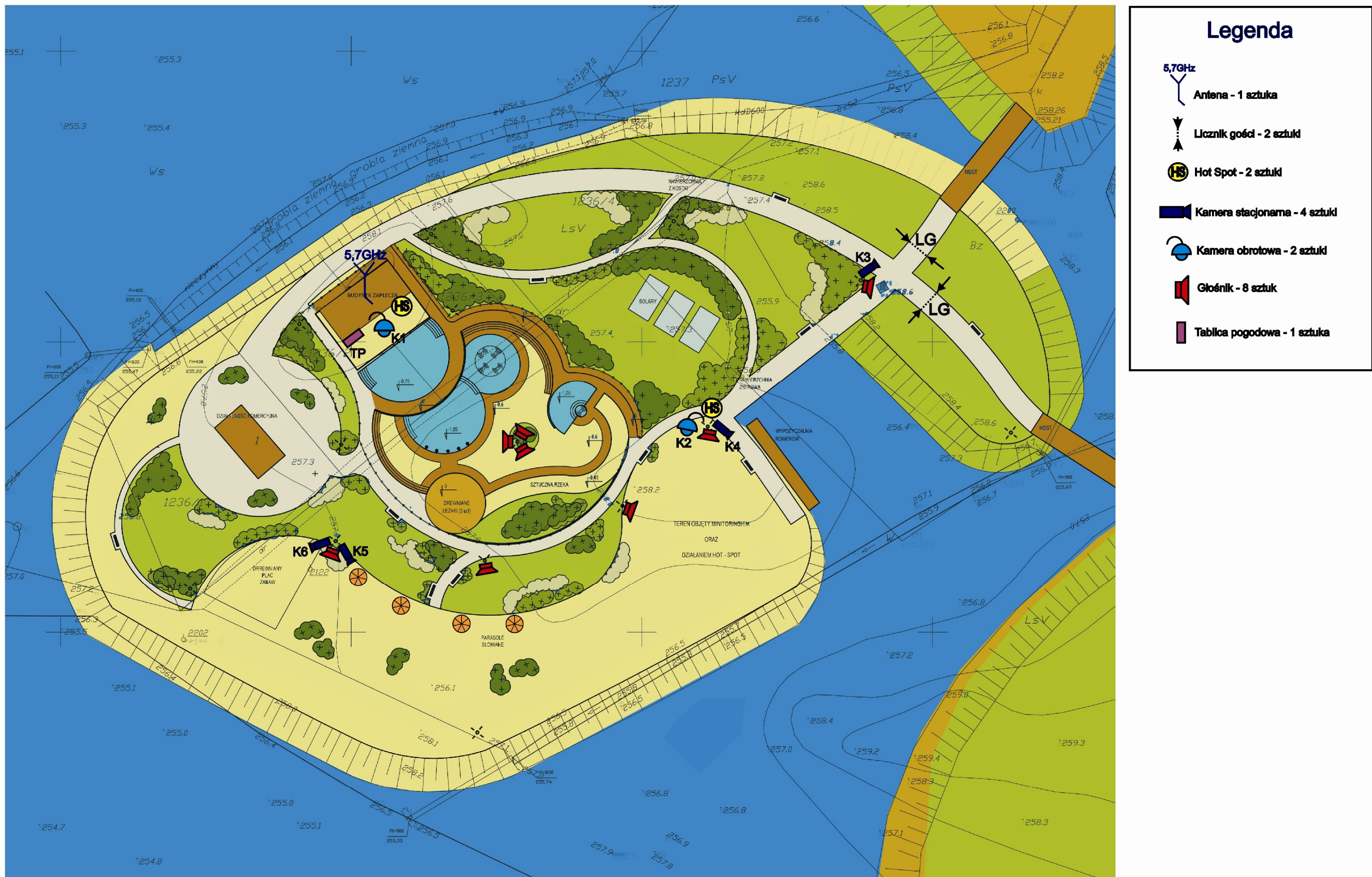
Rys. nr 2. Sugerowane rozmieszczenie elementów teletechnicznych na wyspie
